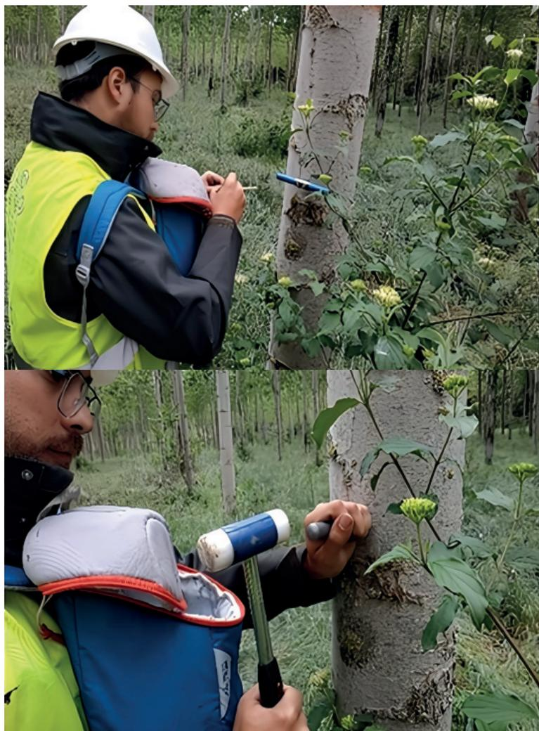
Imagen 5. Detalle de extracción de cores de madera y muestras de fluoema para estimar la densidad básica.
