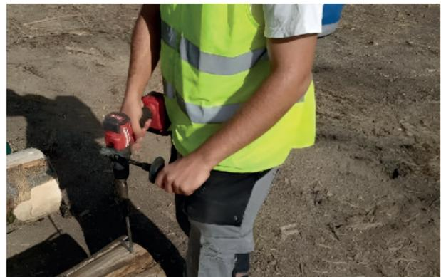
Imagen 5. Obtención de cores en cada troza con barrena de pressler para estimación de densidad de la madera.
