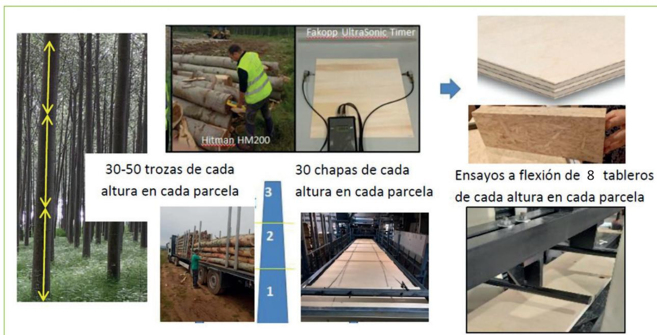
Figura 3. Esquema de seguimiento y caracterización de la madera en rollo al producto.
