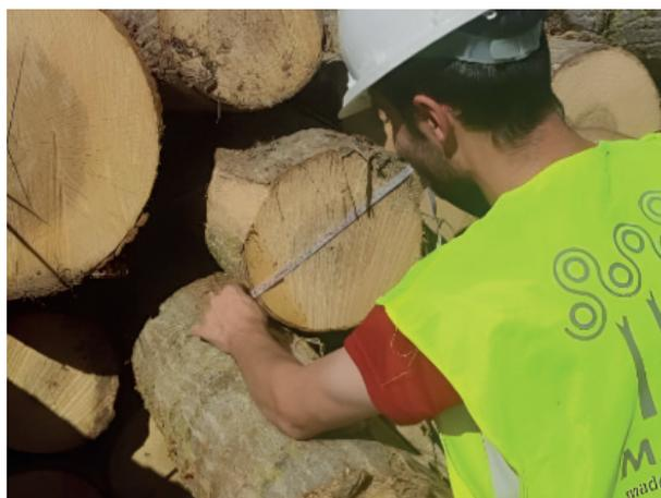
Imagen 3. Medición de diámetro de las testas de cada troza con cinta métrica.
