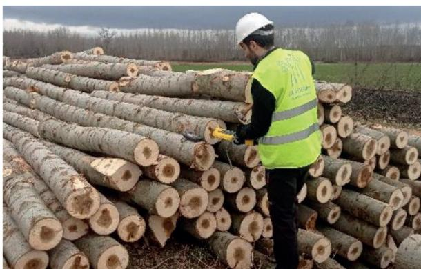
Imagen 4. Medición por método de resonancia de la velocidad de propagación de onda acústica en tronquillo, porción superior del fuste. Equipo Hitman HM200, FiberGen, NZ.
