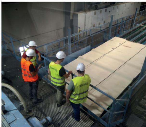
Imagen 6. Proceso de obtención de chapa mediante desenrollo de las trozas en las instalaciones de Garnica
