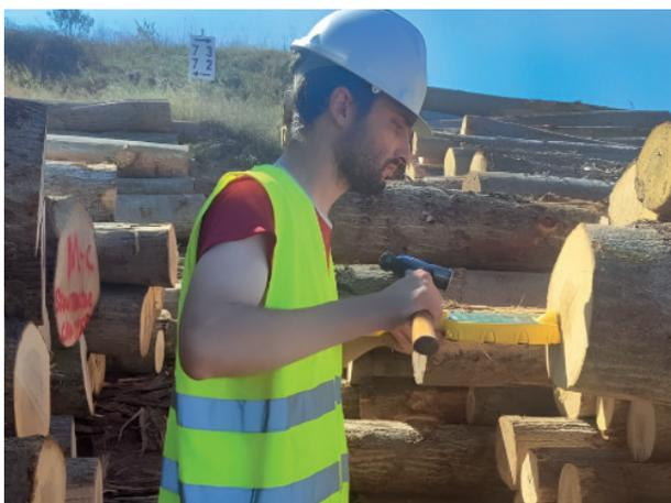
Imagen 2. Medición por método de resonancia de la velocidad de propagación de onda acústica en trozas. Equipo Hitman HM200, FiberGen, NZ.
