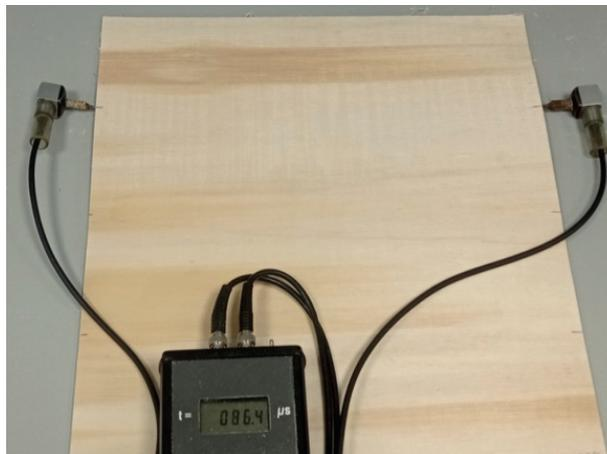
Imagen 7. Detalle de medición con ultrasonidos sobre una muestra de la chapa utilizada para realizar el tablero procedente del mismo grupo de trozas por altura y parcela.
