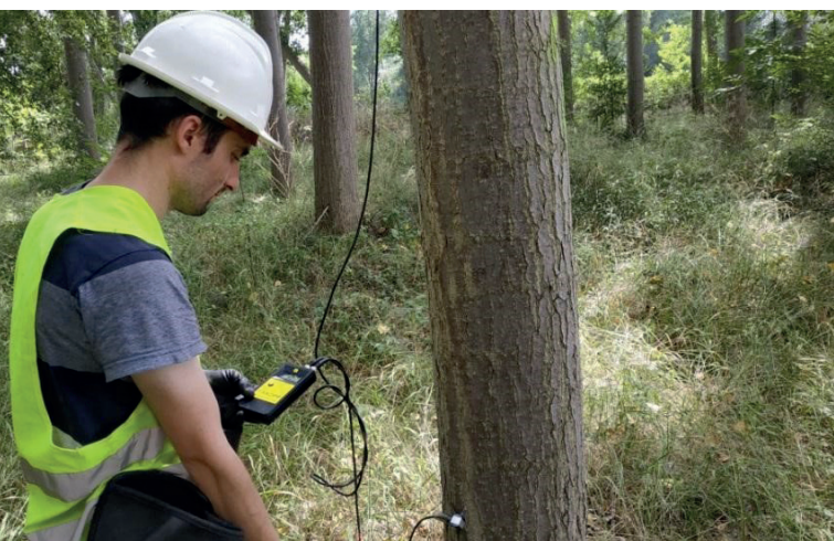
Imagen 4. Detalle de la captura de velocidad de desplazamiento de onda con el equipo Microsecond Timer por Madera Plus.
