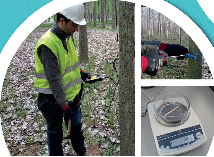
Mediciones en árbol en pie con métodos no destructivos: velocidad acústica y densidad MOE_{dinámico} = V^2 \times Db
