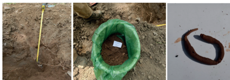
Imagen 3. Ejemplo de una cata de 50 cm realizada (izquierda), etiquetado de la muestra (centro) y testigo de textura moldeado manualmente para estimar la textura aproximada del suelo de acuerdo con la clasificación USDA (dcha).
